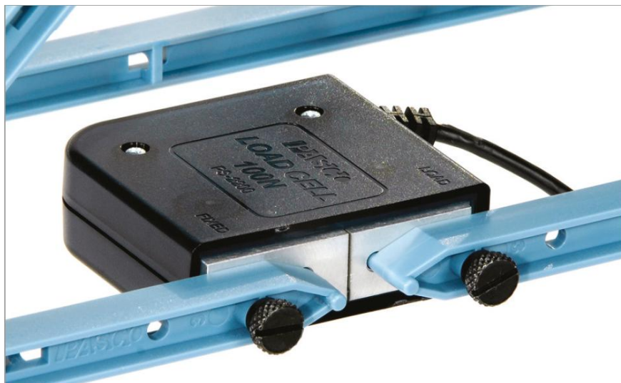
Obr. Detail připojení tenzometru ( http://www.PASCO.cz/produkty/tenzometr-100-n )
