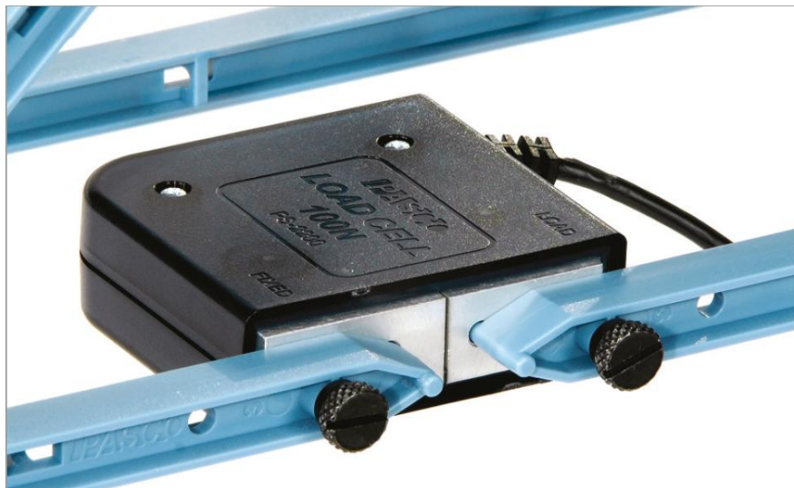
Obr. Detail připojení tenzometru ( http://www.PASCO.cz/produkty/tenzometr-100-n )
